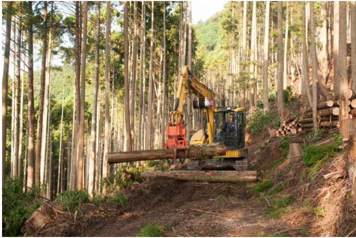
左上：チェーンソー伐採・造材 した丸太をグラップルで整理
